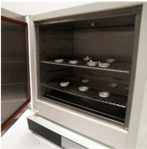
El calor radiante es generado en la parte inferior de la cámara y es difundido, mediante gravedad o mecánicamente, de acuerdo al modelo a todo el volumen de la cámara.
