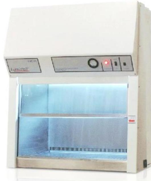
En la parte frontal de la campana, se encuentran: la tapa exterior que cubre la tapa interna de la cámara del filtro, el panel de control y la ventana de cristal deslizable tipo cortina.
